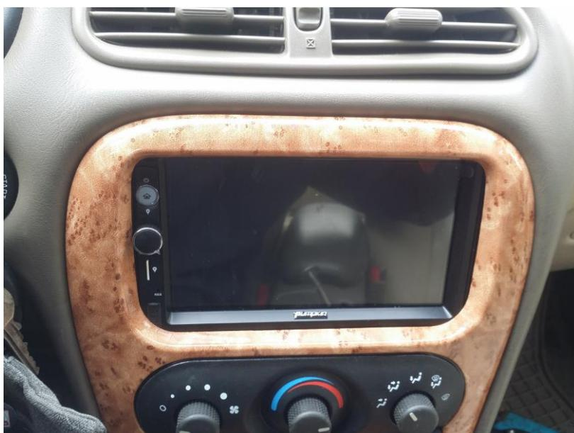
Gerät hinter der Konsole fertig eingebaut
