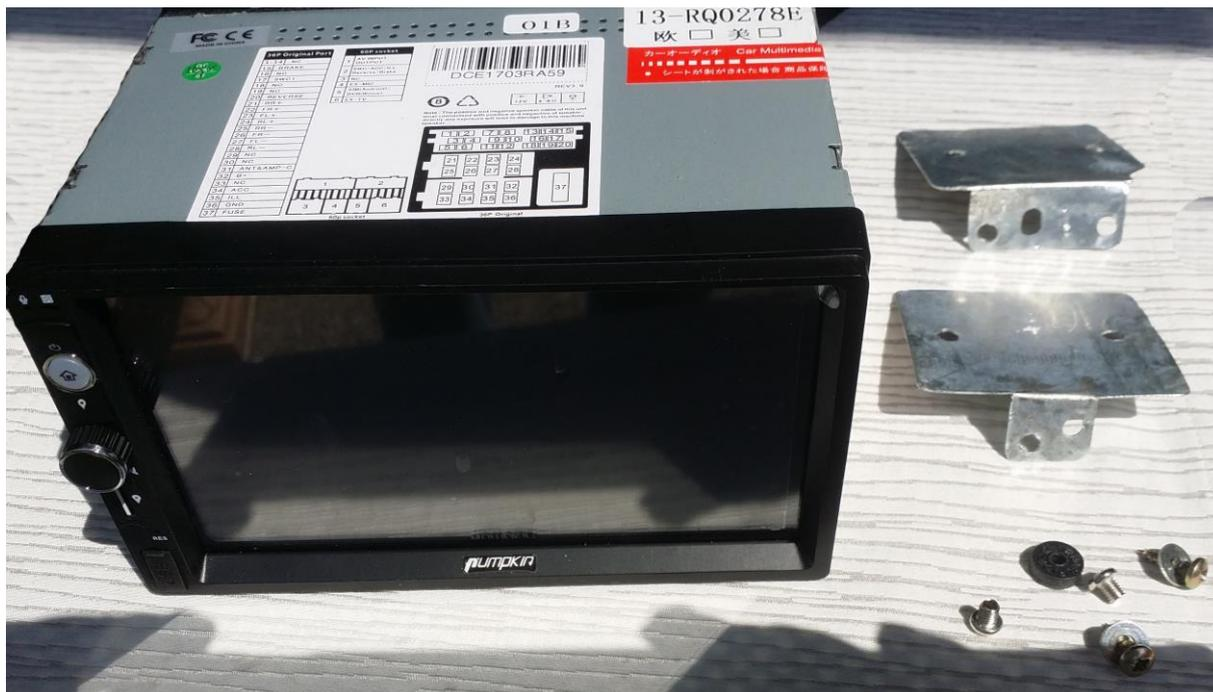
Gerät mit den neu gefertigten Halterungen vor dem Einbau
